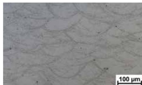
Microestructura después de SR
